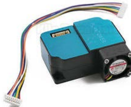
圖 12、PMS3003 空氣品質感測模組
