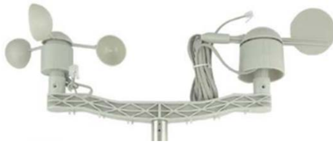
圖 6、風向風速測量模組
