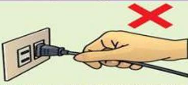
拔下延長線或電器電線時，應手持插頭取下，不可僅拉電線，以免造成電線內部銅線斷裂。
