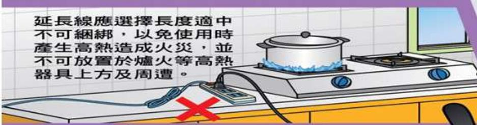
延長線應選擇長度適中不可綑綁，以免使用時產生高熱造成火災，並不可放置於爐火等高熱器具上方及周遭。
